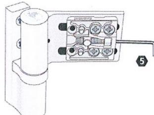
Horizontalverstellung stufenlos  $\pm 5$  mm
